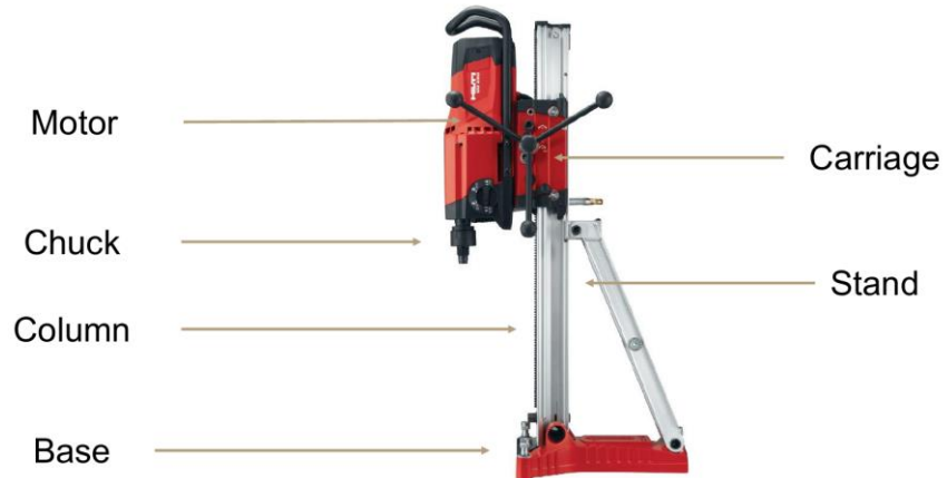
شکل ۳ - اجزای اصلی Motor: Rig، Chuck، Carriage، Column، Base و Stand.
