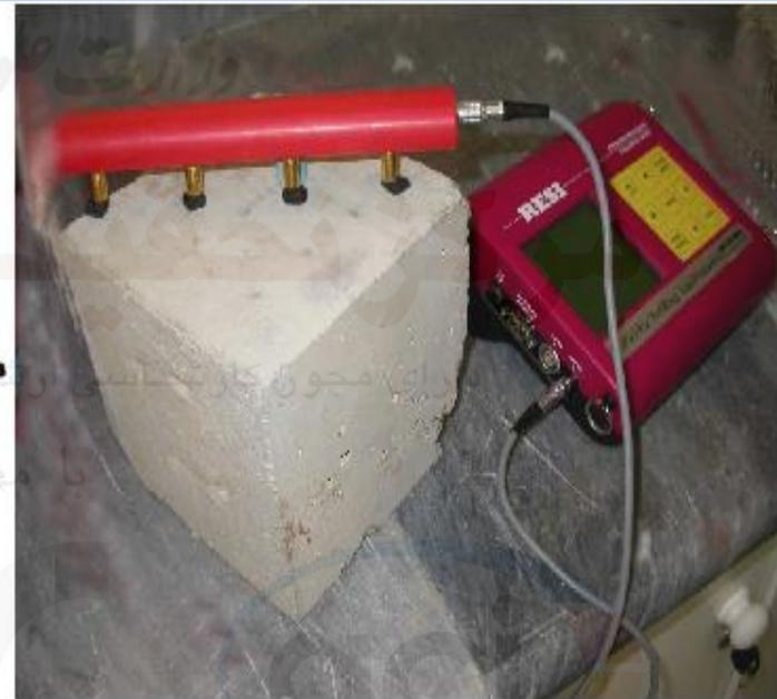
اندازه گیری مقاومت الکتریکی بتن به روش چهار پینه و نر
